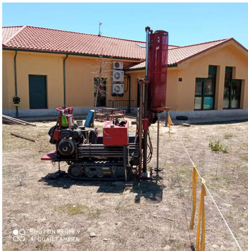
Figura Nº 5.- Trabajos para la realización de la penetración dinámica, tipo DPSH, referida como P-02.
