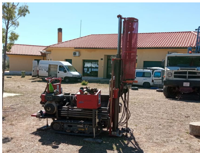
Figura Nº 4.- Trabajos para la realización de la penetración dinámica, tipo DPSH, referida como P-01.
